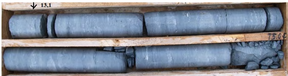
Joonis 10. Uuringuruumi alumises osas lasub väga savikas dolokivi.
