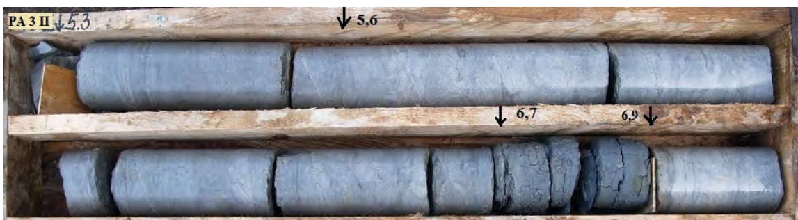
Joonis 11. Läbilõike keskosas lasub keskmiselt 0,2 m paksune domeriidikiht (pa 3 int. 6,7–6,9 m).
